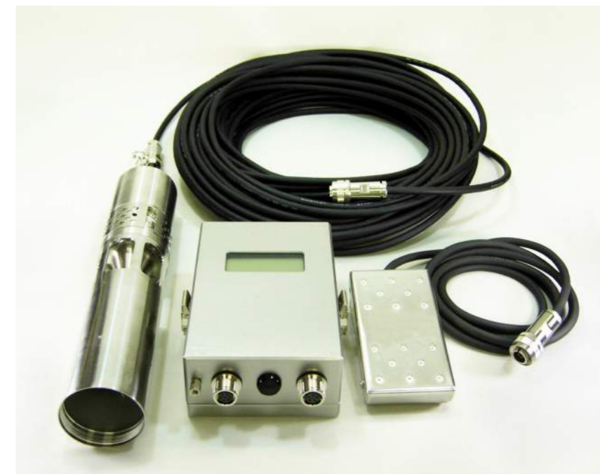
携帯型 油中水分計 NK3型 特許第 6093072 号
